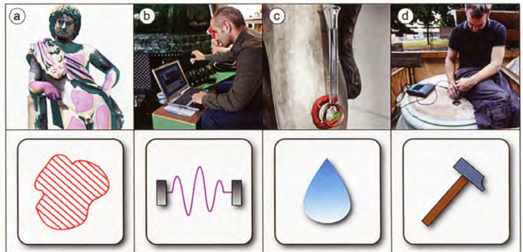
Abb. 2: Methoden zur Zustandsermittlung im Rahmen der konservatorischen Bestandserfassung; a) die Kartierung, b) die Ultraschall-Diagnostik, c) Messungen der Wasseraufnahme mit dem Karstenschen Prüfröhrchen und d) Messung der Oberflächenhärte.
